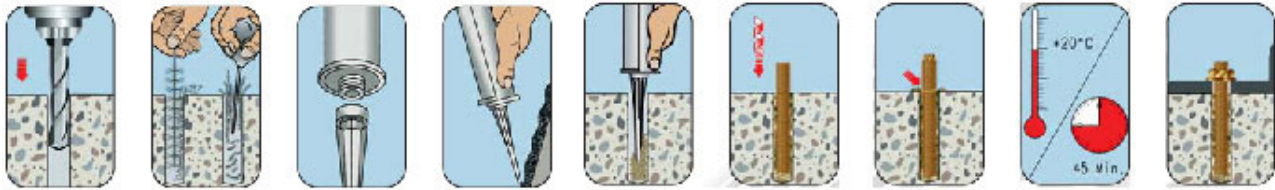
Loch boren Bohrloch reinigen Mischer auf Kartusche schrauben Vor Anwendung ca. 10 cm Schnur auspressen Bohrloch vom Grund auffüllen Armierungseisen bzw. Gewindestange drehend ein-schieben Optische Kontrolle der Mörtelfüllmenge Aushärtezeit beachten Bauteil montieren, Drehmoment aufbringen
